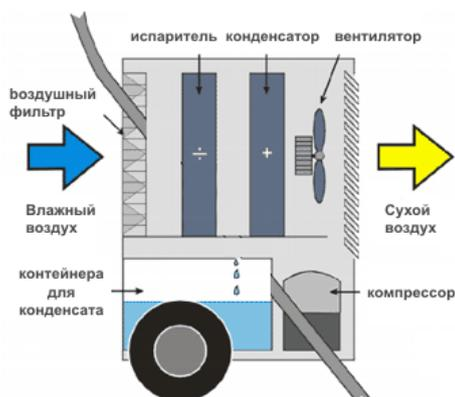
Мобильные устройства, которые находят применение в различного рода помещениях. Использование этого типа конденсаторных осушителей может ускорить проведение многих отделочных и ремонтных работ.
